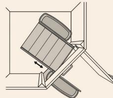
Schwenkkörbe rechts und links ausziehbar.
